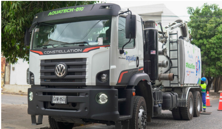
Con el nuevo vehículo se ejecutarán labores de remoción de arena, sedimentos, piedras, residuos sólidos.
