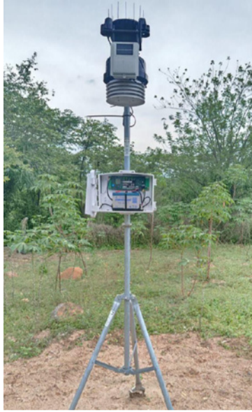
Los equipos permiten medir variables como temperatura, humedad, precipitaciones, velocidad y dirección del viento.
