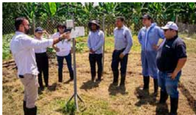
Las estaciones cuentan con sensores de temperatura y humedad del aire, precipitación y radiación solar.
