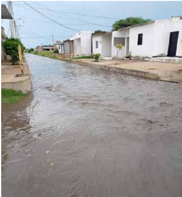
Los afectados manifiestan que esto se origina por la falta de alcantarillado pluvial, una laguna de oxidación y limpieza de los manjoles.
